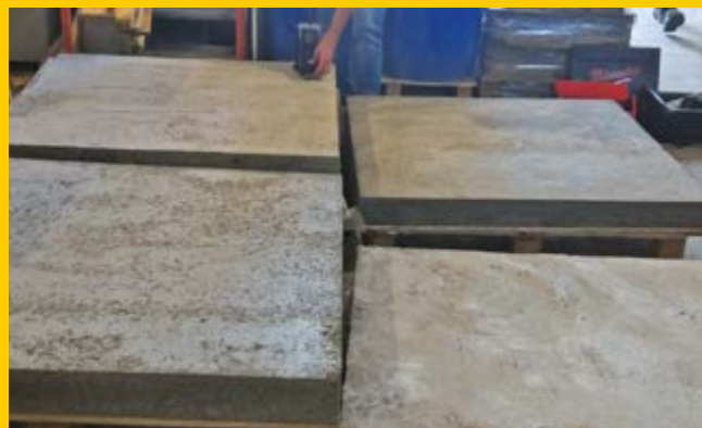
Prove di pull-out sui campioni di massetti leggeri premiscelati (prima e dopo il test) con varie tipologie di fissaggio e a varie profondità.
