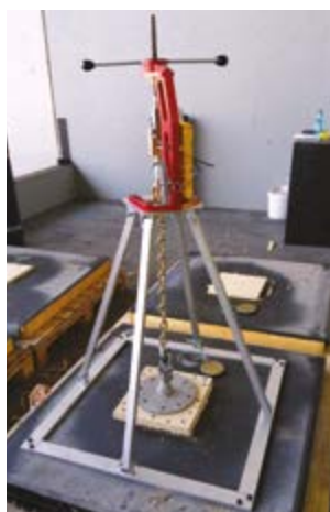
Test di pull-out secondo ANSI/SPR11A-1-2010.
