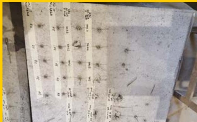
Prove di pull-out sui campioni di massetti leggeri premiscelati (prima e dopo il test) con varie tipologie di fissaggio e a varie profondità.
