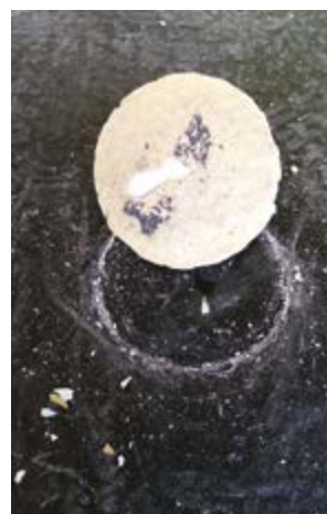
Lecamix dopo il test di pull-out secondo UNI EN 13596
