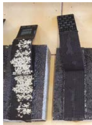
Prove di peeling di membrane in bitume polimero sui supporti in Lecamix.
