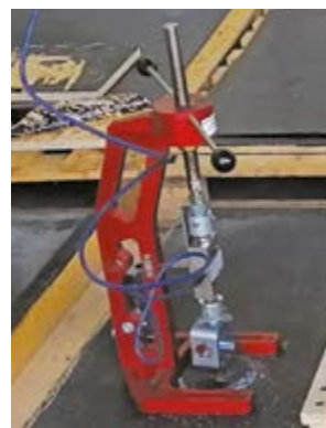
Attrezzatura per il test di pull-out secondo UNI EN 13596 con disco metallico totalmente incollato alla faccia superiore della membrana
