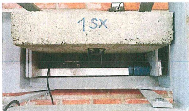
Figura 7 – Sistema di contrasto per la mensola
