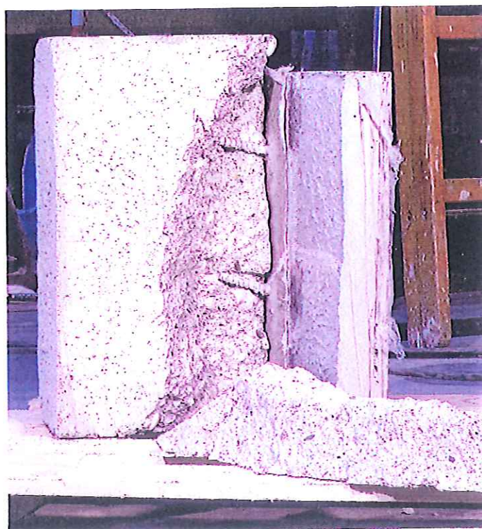
Fotografia 3: CS Concrete campione 31 - aspetto del campione al termine della prova.-
