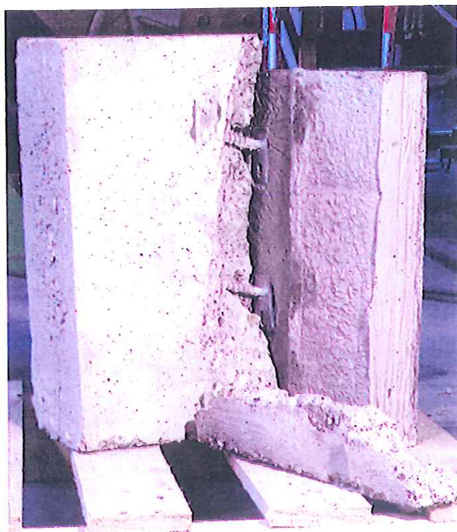
Fotografia 6: CS Concrete campione 32 - aspetto del campione al termine della prova.-
