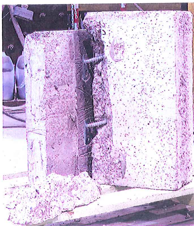
Fotografia 9: CS Concrete campione 33 - aspetto del campione al termine della prova.-
