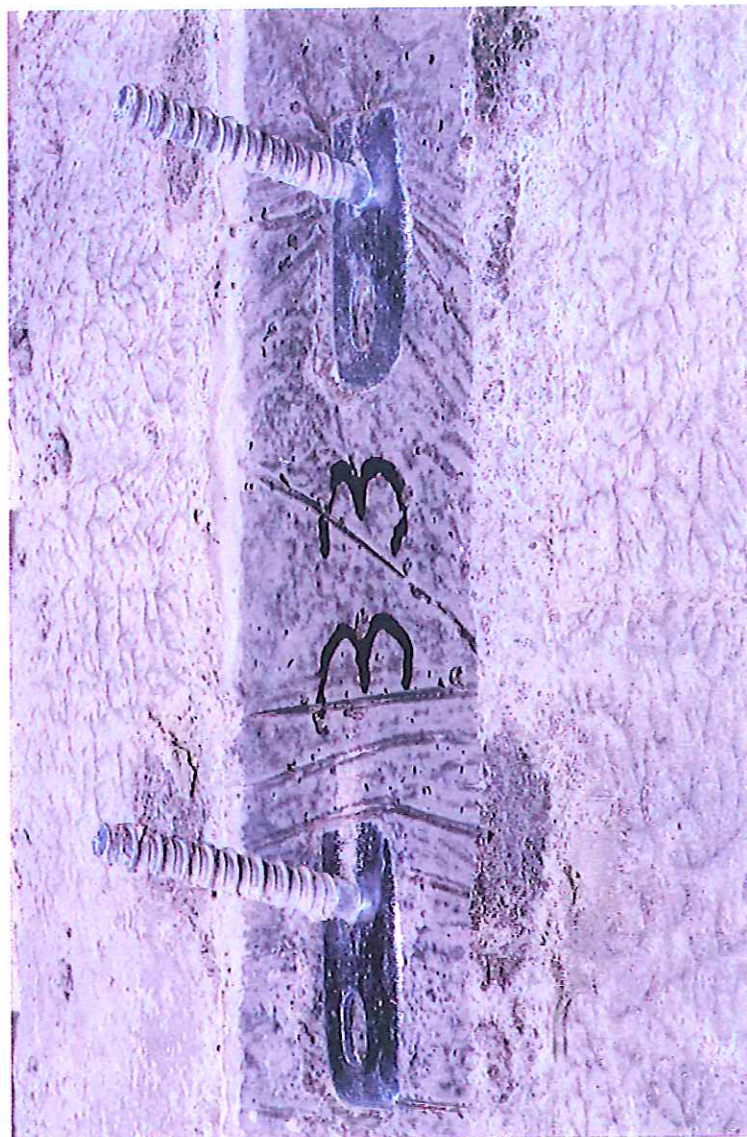
Fotografia 10: CS Concrete campione 33 - aspetto della giunzione al termine della prova.-
