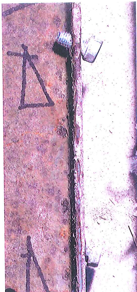
Fotografia 3: CS Steel campione 4 - dettaglio della giunzione al termine della prova.-
