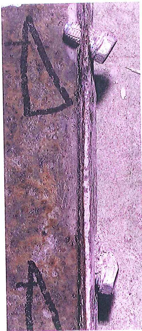
Fotografia 6: CS Steel campione 5 - aspetto della giunzione al termine della prova.-
