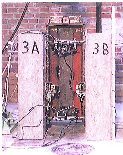
Fotografia 10: CS Steel campione 3 - complessivo all'inizio della prova.-
