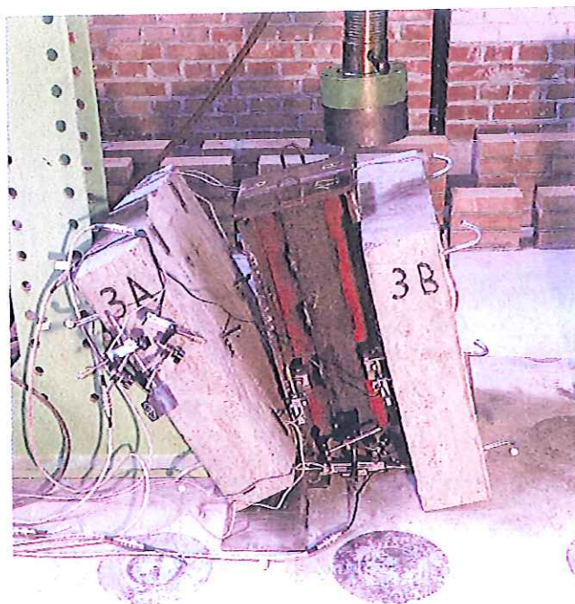
Fotografia 11: CS Steel campione 3 - aspetto del campione al termine della prova.-
