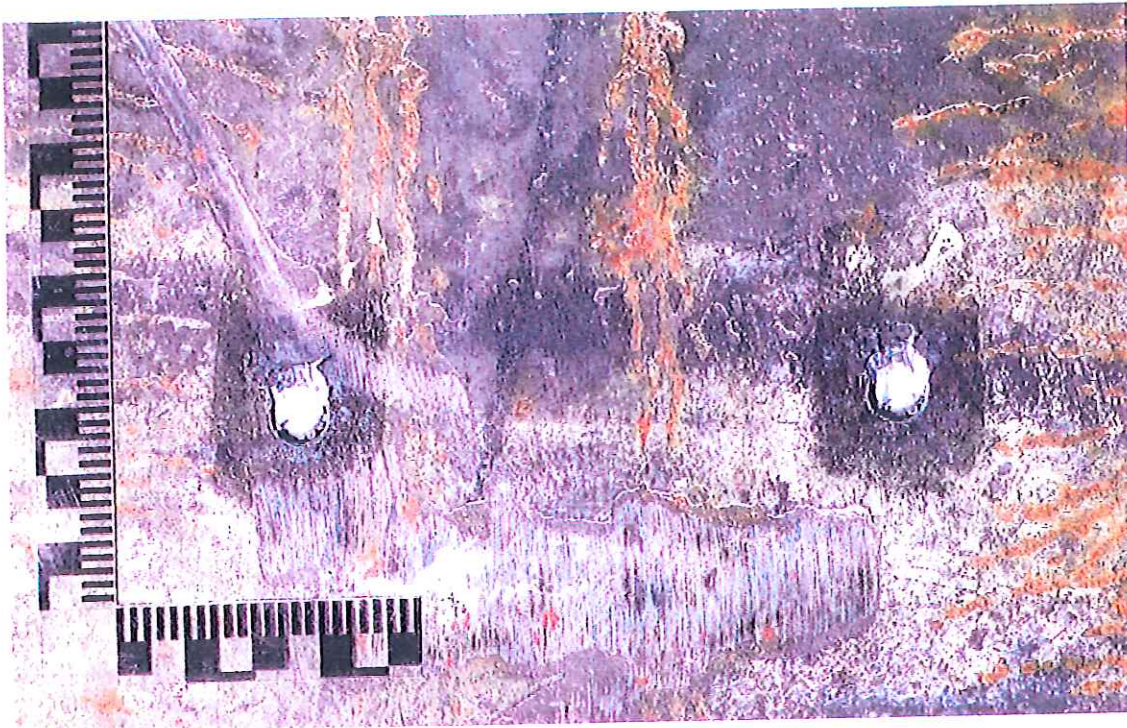
Fotografia 13: CS Steel campione 3 - aspetto della giunzione al termine della prova lato acciaio.-
