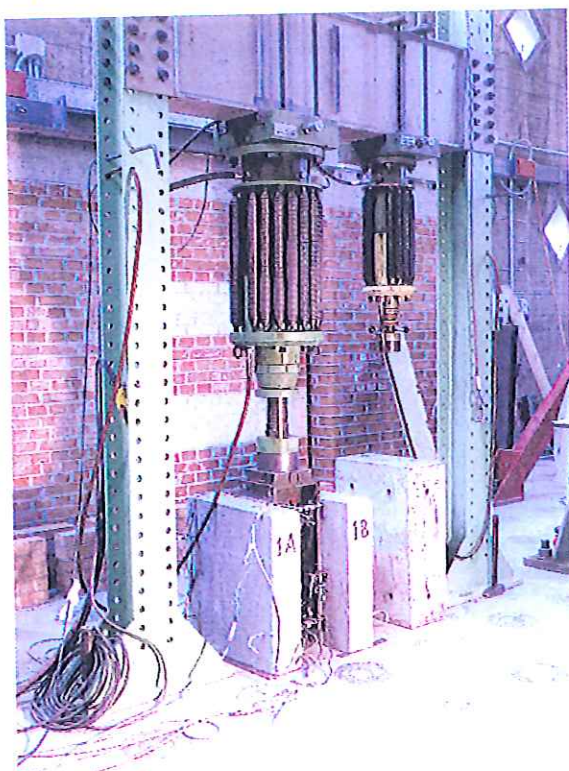
Fotografia 1: disposto di prova e disposizione degli strumenti di misura su di un lato del campione, simmetrico rispetto quello posteriore. -
