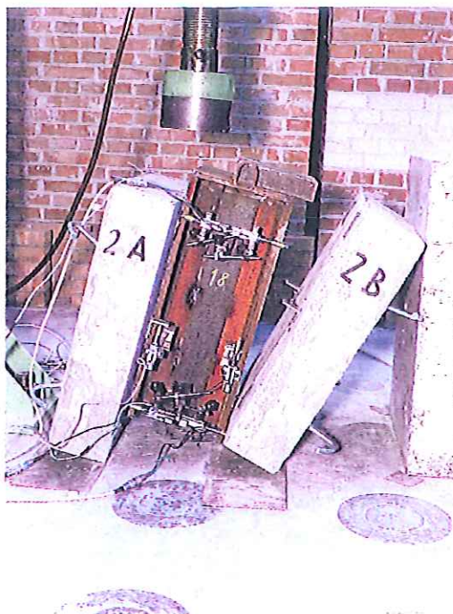
Fotografia 7: CS Steel campione 2 - aspetto del campione al termine della prova.-
