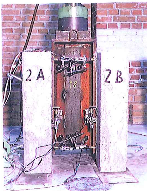
Fotografia 6: CS Steel campione 2 - complessivo all'inizio della prova.-
