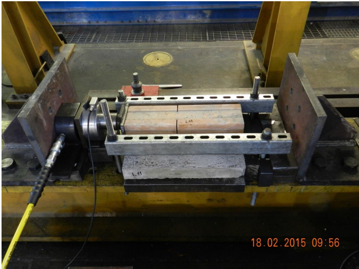
Set-up sperimentale impiegato per la realizzazione di prove su interfaccia calcestruzzo/fondello in laterizio
