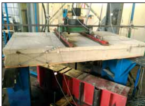
Figura 88: Allestimento del secondo solaio di h 12 + 5 cm.
