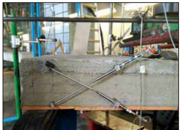
Figura 23: Strumenti per misurare le deformazioni a taglio.
