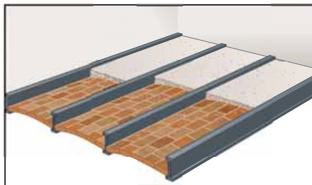
Figura 4: Voltine ad estradosso curvo e voltine curve "volterrane".
