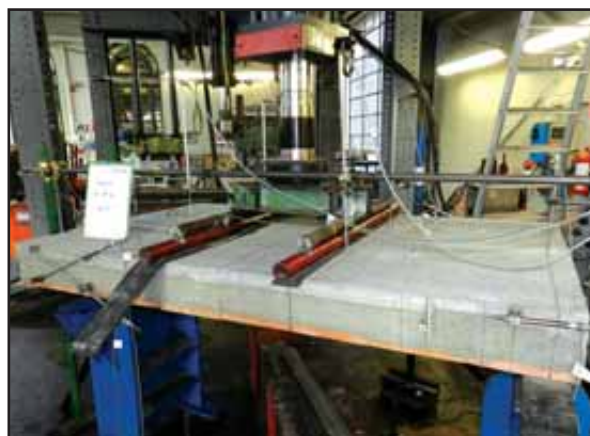
Figura 94: Allestimento del secondo solaio di h 16 + 5 cm.
