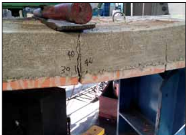
Figura 85: Fessura flessionale del secondo solaio di h 12 cm.
