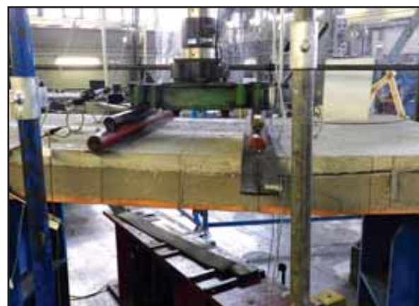
Figura 93: Rottura del primo solaio di h 12 + 5 cm.
