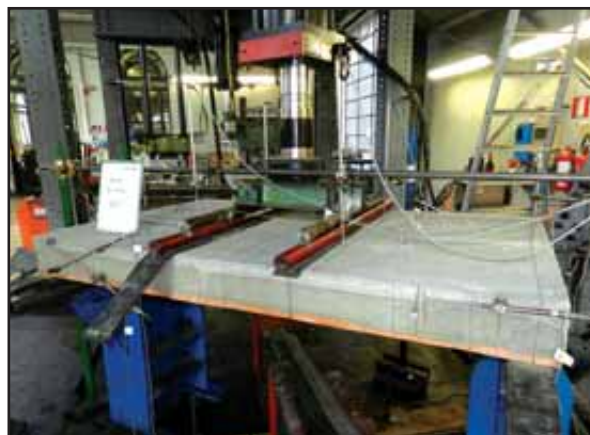
Figura 92: Allestimento del primo solaio di h 16 + 5 cm.
