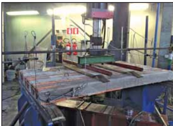
Figura 83: Allestimento del primo solaio di h 12 cm.
