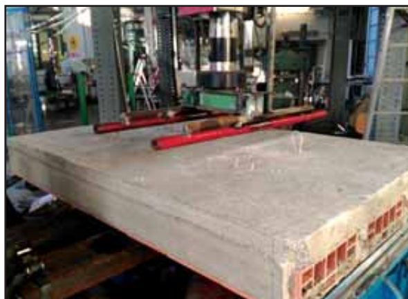
Figura 86: Allestimento del primo solaio di h 12 + 5 cm.
