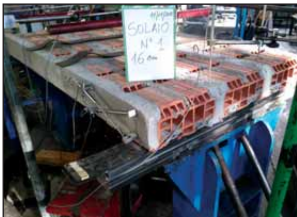
Figura 89: Allestimento del primo solaio di h 16 cm.
