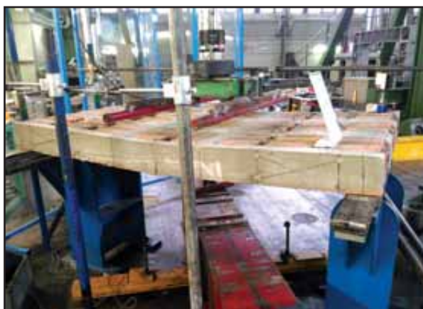
Figura 90: Rottura del secondo solaio di h 16 cm.
