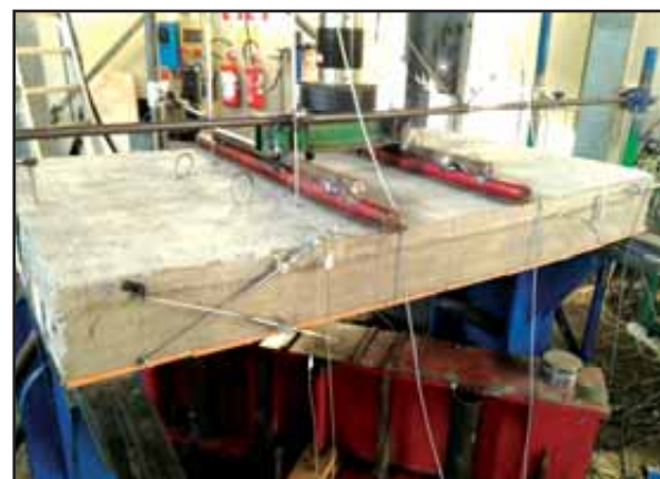
Figura 87: Rottura del primo solaio di h 12 + 5 cm.
