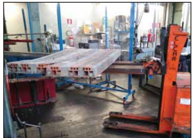
Figura 27: Carrello elevatore per disporre il solaio nella posizione corretta.
