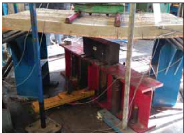
Figura 84: Rottura del secondo solaio di h 12 cm.
