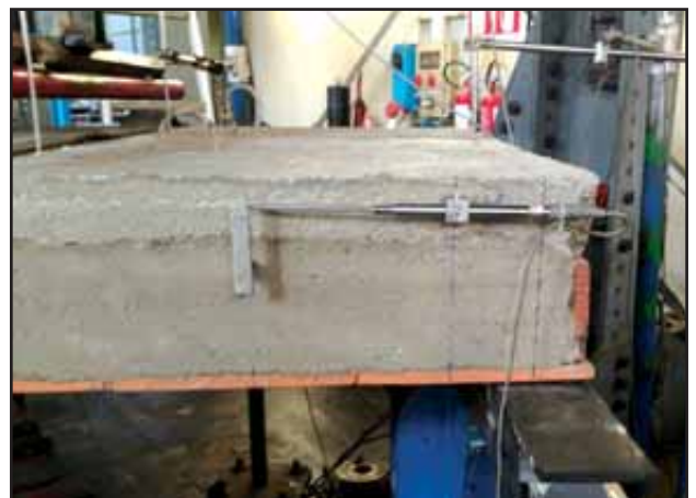
Figura 24: Strumenti per misurare lo scorrimento tra le due parti del solaio.
