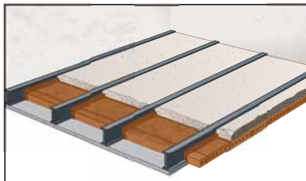
Figura 5a: Singolo tavellone appoggiato e cappa in calcestruzzo.
