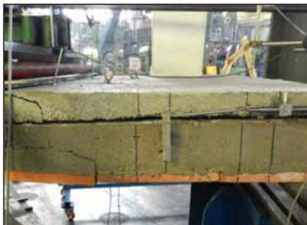
Figura 34: Rottura 1° solaio consolidato h = 12 + 5 cm.
