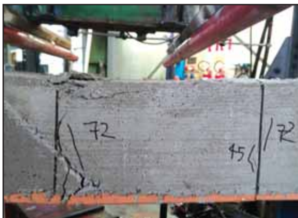
Figura 91: Fessura laterale del secondo solaio di h 16 cm.
