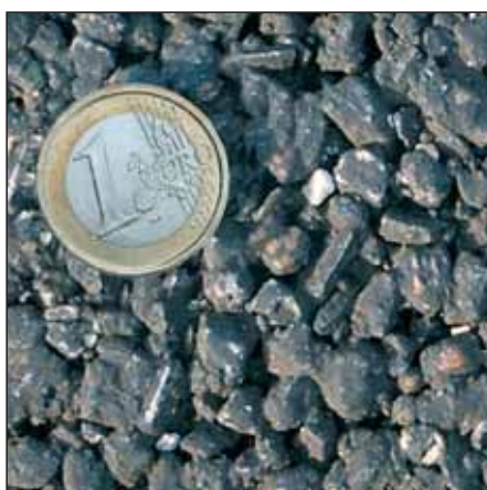
Particolare di tappeto microdrenante dopo 16 mesi di esercizio.
