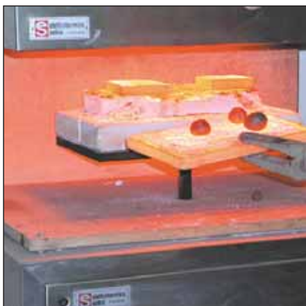
Controllo dell'espansione del granulo di argilla espansa.
