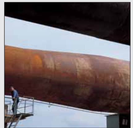
Il forno rotante per la cottura dell'argilla.
