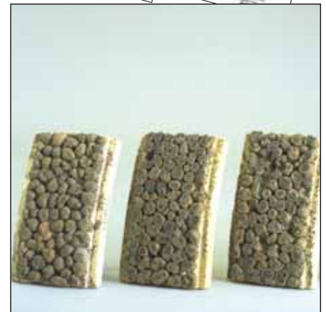
Leca del tipo Resistente e Strutturale (sopra), Basalto e Calcare (sotto) assoggettati ad usura in laboratorio.
