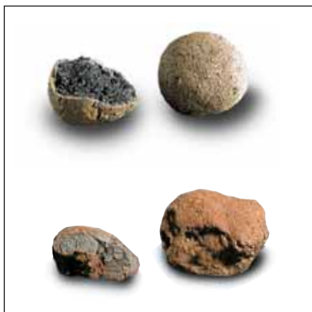
Granuli di Leca (in alto) e Leca Strutturale (in basso): la struttura porosa del materiale costituente il granulo è racchiusa in una scorza dura e resistente.
