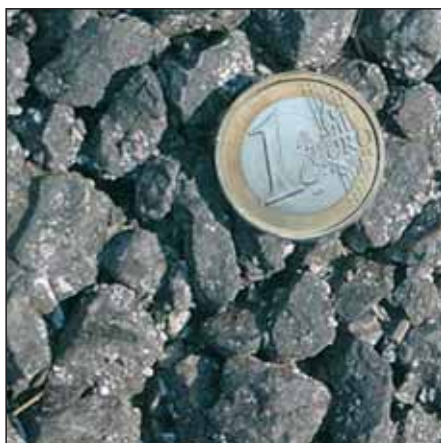
Particolare di tappeto drenante dopo 12 mesi di esercizio.
