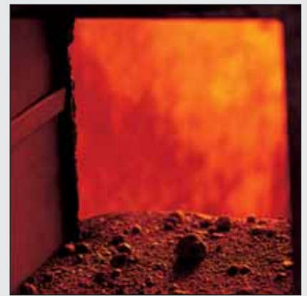
La cottura a 1.200 °C e il processo di espansione.
