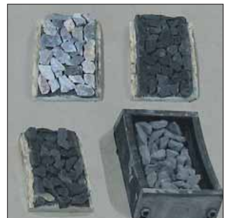
Leca del tipo Resistente e Strutturale (sopra), Basalto e Calcare (sotto) assoggettati ad usura in laboratorio.
