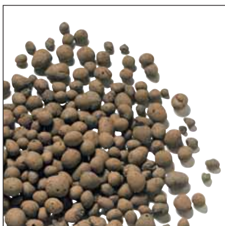
Granuli di Leca (in alto) e Leca Strutturale (in basso): la struttura porosa del materiale costituente il granulo è racchiusa in una scorza dura e resistente.
