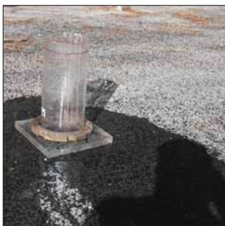
Prova di capacità drenante.
