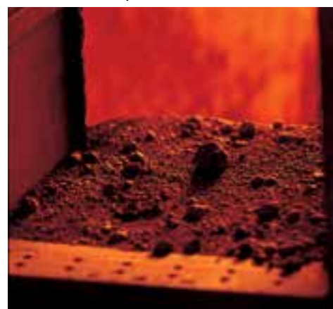
Cottura a 1.200 gradi ed espansione.
