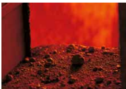
Cottura a 1.200 gradi ed espansione.
