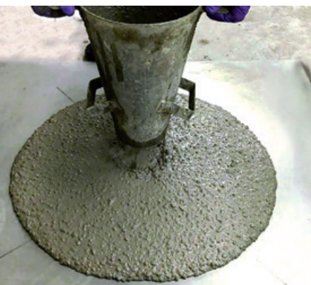
Prova di spandimento.
