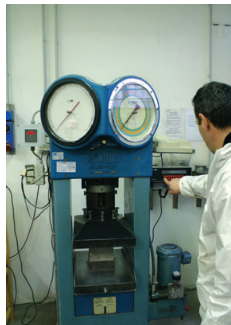
Pressa per determinazione resistenza a compressione.
