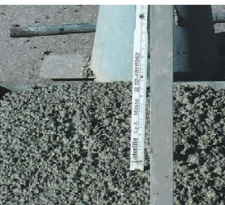
Prova con cono di Abrams.
