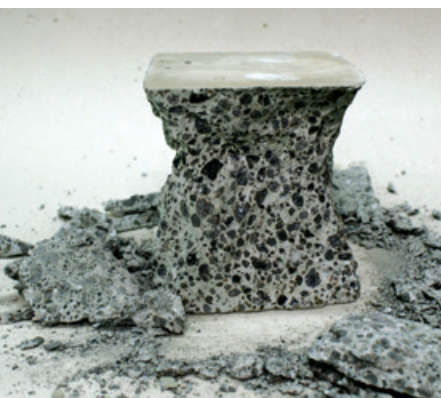
Cubetto sottoposto a rottura.
