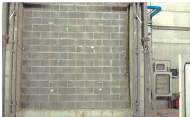
Foto della parete di prova (lato esposto al fuoco dopo la prova).
