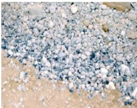
Fig. 4.3 : grani di argilla espansa frantumati in seguito al passaggio diretto del mezzo vibrante durante la compattazione.
