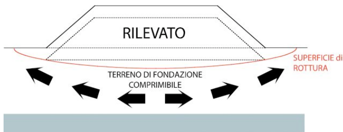
Fig 3.8 : stato limite ultimo per estrusione del terreno di fondazione.
