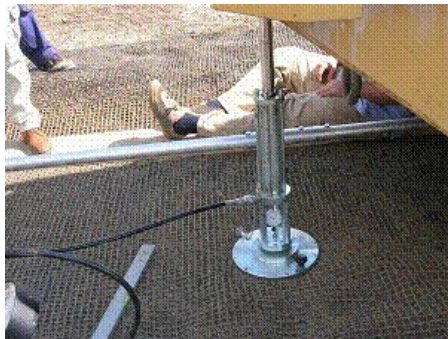
Fig. 5.9 : esecuzione di una prova su piastra su rilevato rinforzato.
