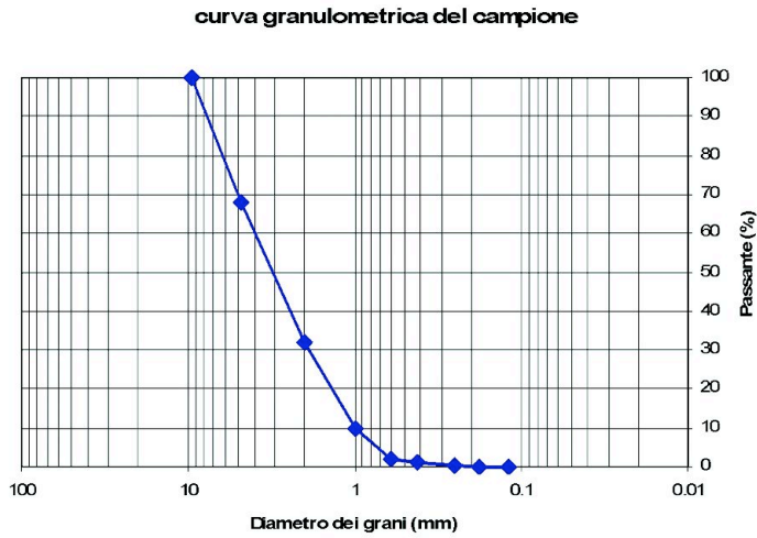
Fig. A1 : curva granulometrica del campione sottoposto a prova edometrica.
